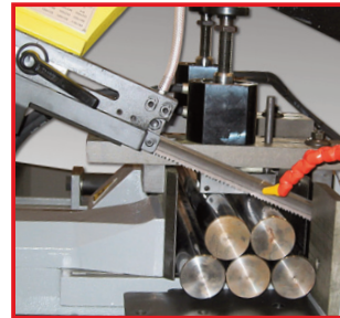
MV-AVD JUPITER Morse verticali per il taglio a pacco. Oleodynamic device for bundle cutting. Serrages verticaux hydrauliques pour paquets.
