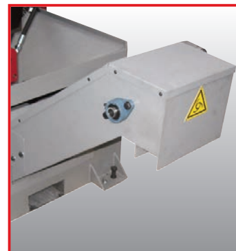
ST Scaricatore trucioli. Swarf extractor. Évacuateur de copeaux.
