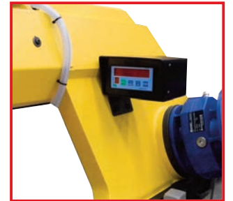
VAT JUPITER Visualizzatore angolo di taglio. Cutting angle display. Visualisation de l'angle de coupe.
