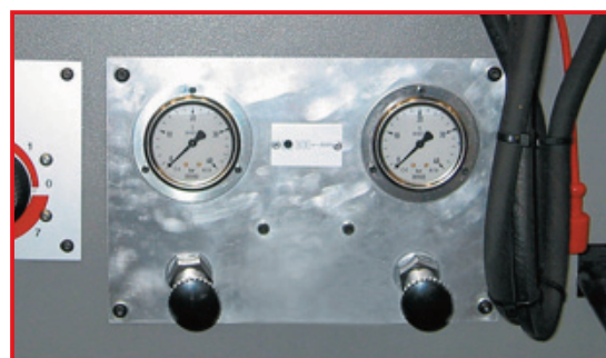
RPM2 Regolazione pressione morsa. Vice pressure adjustment. Reglage de la pression de serrage de l'etau.
