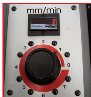
VDA Visualizzazione velocità discesa arco. Head drop speed visualization. Visualisation vitesse descente archet.
