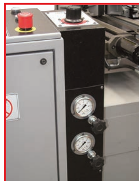
RPM2 Regolazione pressione morsa. Vice pressure adjustment. Reglage de la pression de serrage de l'etau.
